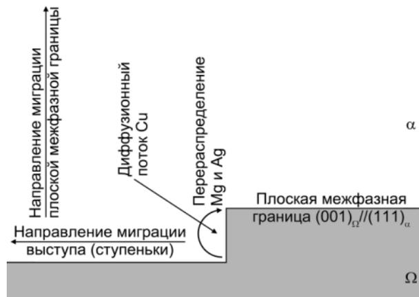
Рисунок 1.1 – Схема распределения магния и серебра при миграции выступа(ступеньки) вдоль плоской межфазной границы  $(001)_{\Omega} // (111)_{\alpha}$
