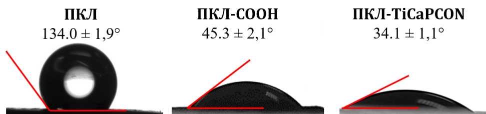
Рисунок 22 – Контактный угол смачивания необработанных волокон (ПКЛ), плазменно-модифицированных волокон (ПКЛ-СООН), ПКЛ, покрытых TiCaPCON
