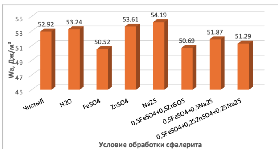
Рисунок 3.34 – Значение работы адгезии поверхности обработанного сфалерита реагентами-модификаторами в растворе бутилового ксантогената калия
