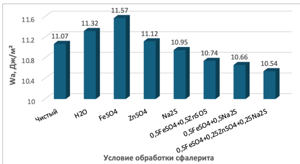
Рисунок 3.33 – Значение работы адгезии ТГКК к поверхности таблетки из зерен сфалерита, предварительно обработанных реагентами-модификаторами в дистиллированной воде
