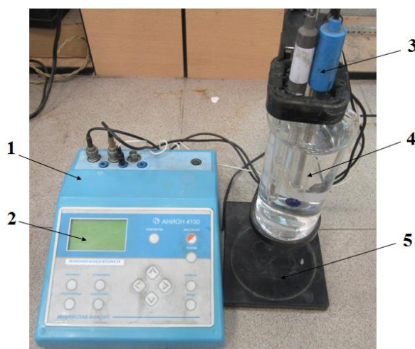
Рисунок 2.12. Иономер И-160М: 1 – блок-преобразователь; 2 – дисплей для визуализации параметров pH и Eh; 3 – измерительный электрод; 4 – стаканчик; 5 – штатив
