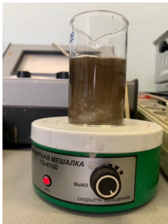
Рисунок 2.10. Схема смешения раствора реагентов с минеральным порошком
