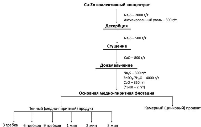
Рисунок 5.4 – Схема опытов по изучению кинетики селективной флотации коллективного медно-цинкового концентрата
