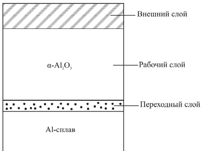
Рис. 1. Типичное строение микродуговых покрытий на алюминиевых сплавах
