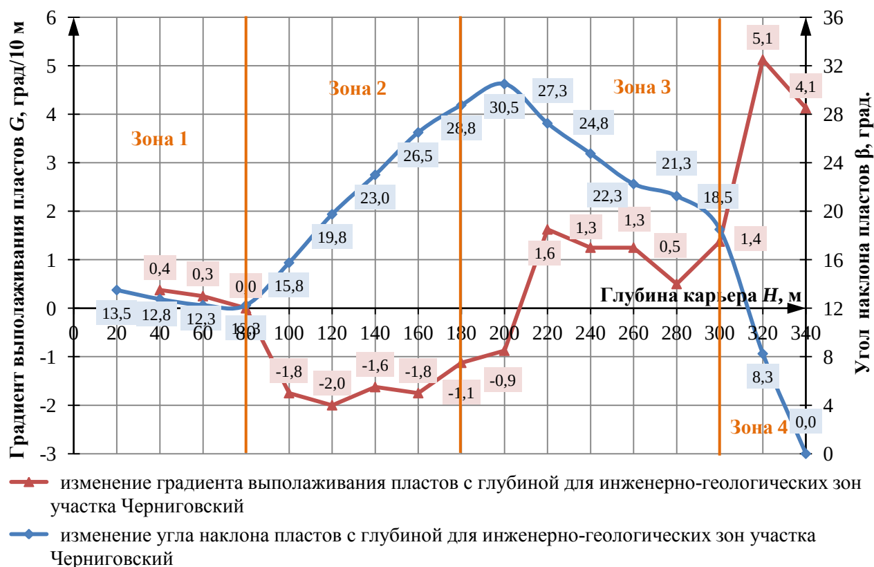
Рисунок 2.2 – Изменение градиентов выполаживания пластов по характерным сечениям северо-западной части замковой зоны Кедровско-Крохалевской брахисинклинали: зона 1–4 – инженерно-геологические зоны участка, выделенные по характеру изменения градиентов выполаживания
