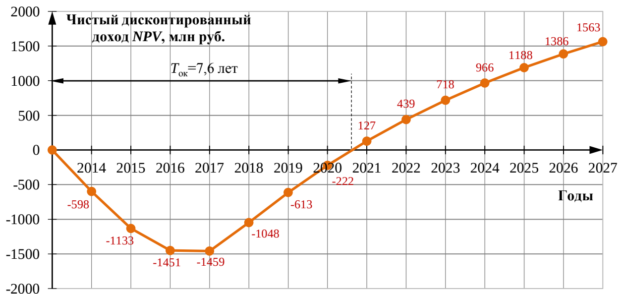
Рисунок Б7 – Изменение чистых дисконтированных денежных потоков от инвестиционной и операционной деятельности при реализации проекта строительства комплекса ЦПТ на разрезе «Черниговский»: T_{ок} – срок окупаемости капитальных затрат
