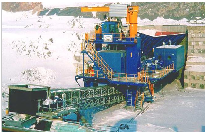
Рисунок Б2 – Полумобильная дробильная установка на разрезе «Талдинский» («Tenova TAKRAF») [39, см. список использованных источников]
