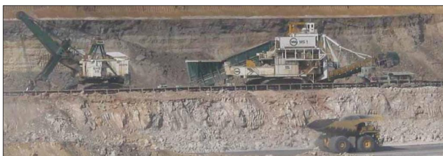
Рисунок Б4 – Погрузка горной массы экскаватором P&H 2800 в передвижную дробильную установку «MMD» (разрез «Goonyella») [96, см. список использованных источников]
