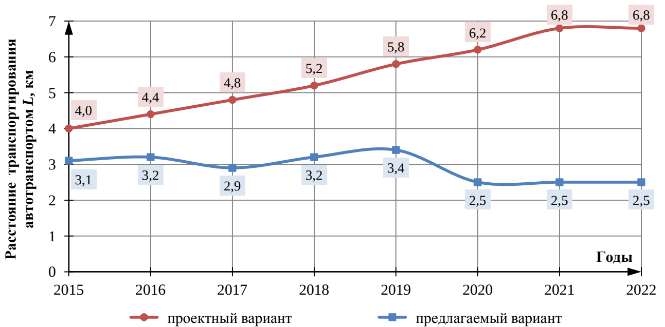
Рисунок 4.24 – Кривые, иллюстрирующие возможность регулирования расстояний транспортирования вскрышных пород автотранспортом (выполнено для условий разреза «Черниговский»)
