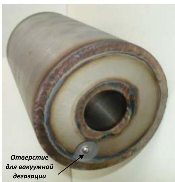
Рисунок 86 - Вид трехслойного трубного «пакета» после вакуумной заварки
