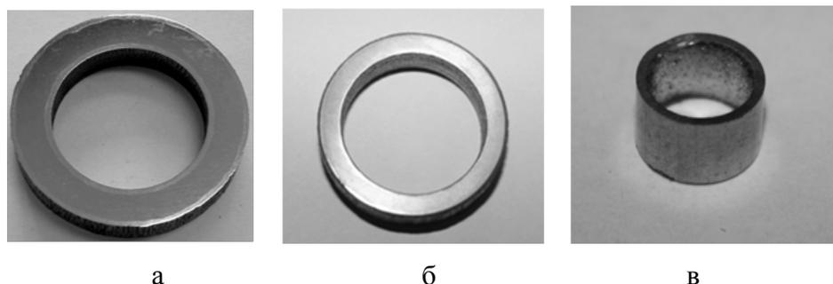
Рисунок 91 – Кольцевые образцы, вырезанные из трехслойных труб на разных технологических этапах: а - образец № 1:  $30 \times 19,4 \times 5,3$  мм; б - образец № 2:  $21 \times 14 \times 3,5$ ; в - образец № 3:  $15 \times 10,4 \times 2,3$  мм
