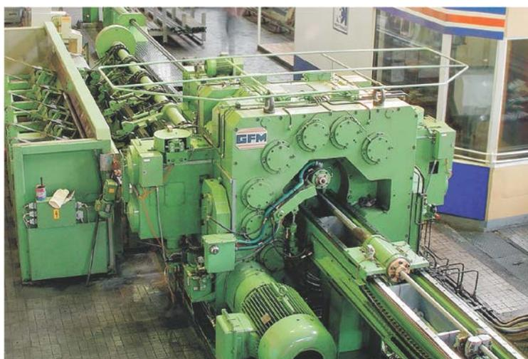
Рисунок 87 – Ковочный комплекс SKK-10 для радиальнойковки
