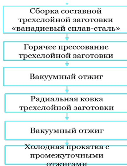
Рисунок 12 – Принципиальная схема изготовления трехслойной трубы из ванадиевого сплава и коррозионностойкой стали на промышленном оборудовании
