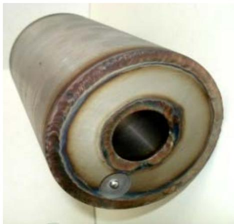
Рисунок 13 – Трехслойная трубная заготовка после вакуумной заварки
