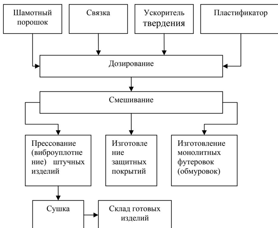
Рис. 7 – Схема производства формованных (штучных) и неформованных (тиксотропные сырьевые смеси) огнеупоров из отходов (боя огнеупорных изделий)
