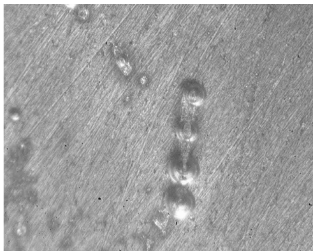
Рис. 8 (б) Протекание катодной реакции сосредоточено по включениям. Видны включения и пузырьки водорода. Снимок выполнен во время свободной коррозии образца Al-1Sn в растворе 0.5M Na 2 SO 4 . Увеличение около 150х
