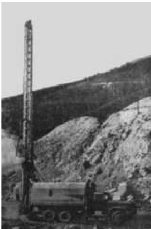
Рисунок 1.3 – Станок термического бурения СБО-5 КБ-БРЦ ЮГОК
