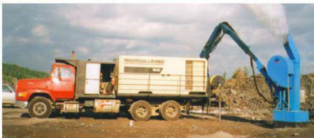
Рисунок 1.6 – Станок термического расширения взрывных скважин «DRAGON»
