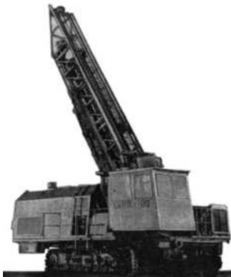
Рисунок 1.2 – Карьерный станок комбинированного бурения СБШК-200 ЗАО «УГМК - РУДГОРМАШ»
