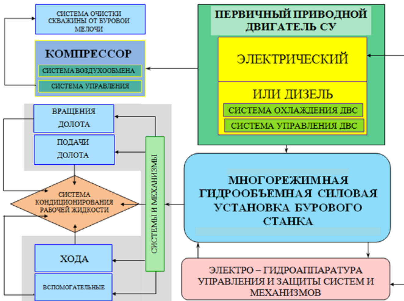
Рисунок 1.20 – Структурная схема многорежимной гидрообъемной силовой установки, выполненной по системе «единого вала»
