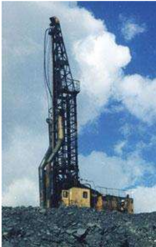
Рисунок 1. 5 – Станок термического расширения СБТ – 400 МНР ЗАО «УГМК – РУДГОРМАШ»
