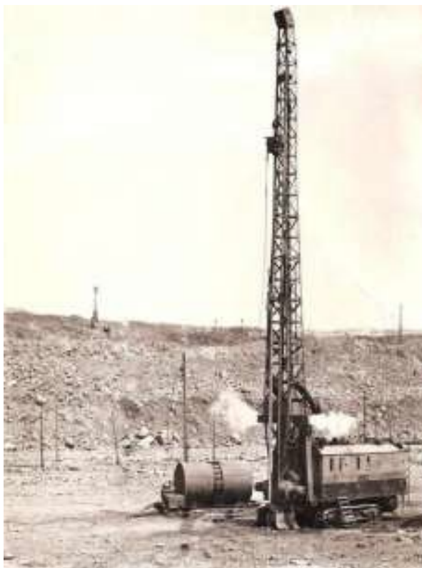
Рисунок 1.1 – Станок термического бурения на железорудном карьере Бакальского РУ
