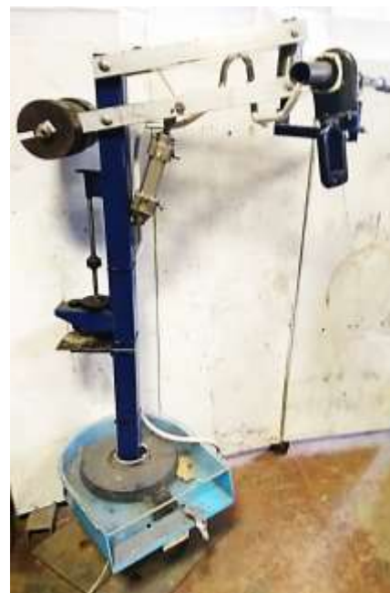
Рисунок 1– Конструктивная схема ( а ) и экспериментальный образец ( б ) модернизированного манипулятора для извлечения отработанного разливного стакана: 1 - привод, 2 – тумба, 3 – опорный шарикоподшипник, 4 - вертикальный стержень, 5 – диск (зубчатое колесо?), 6 - подшипники скольжения, 7 – колонна, 9 – рычаг, 10 – контргруз, 11 – рычаг, 12 – обойма, 13 – консоль, 14 – шарнирная опора, 15 – подвеска. 16 – гидравлический механизм
