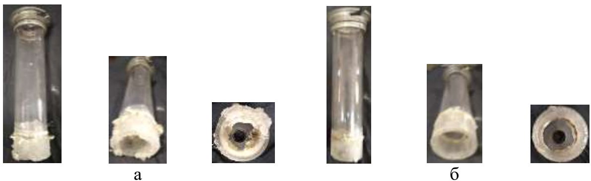
Рисунок 9 – Форма и толщина слоев имитатора настыли, образовавшихся в нижней части модели защитной трубы при симуляции разливки в случаях отсутствия (а) и наличия вибрационного воздействия (б)
