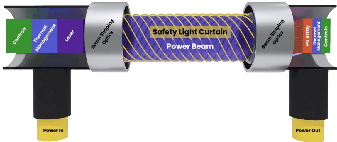
Рисунок 1.4 – Принцип передачи энергии в свободном пространстве
