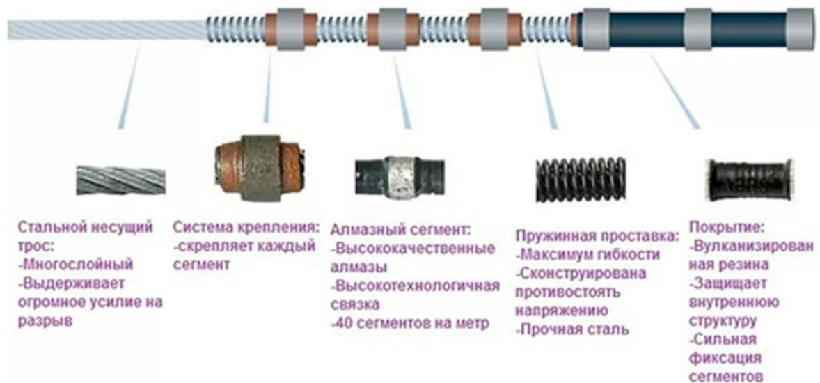
Рисунок 3 – Схема каната для алмазного распиливания [81]
