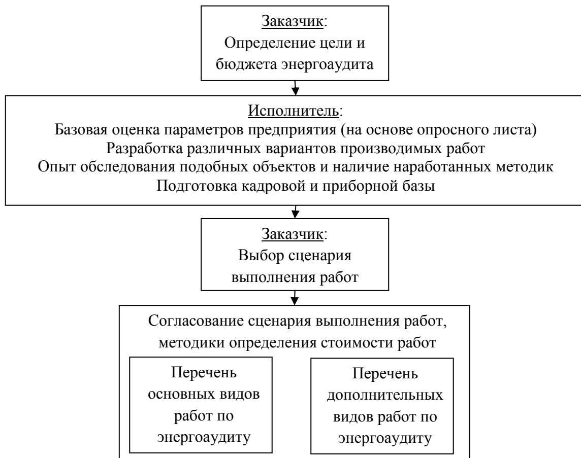
Рис. 2.6. Предварительный этап проведения энергоаудита
