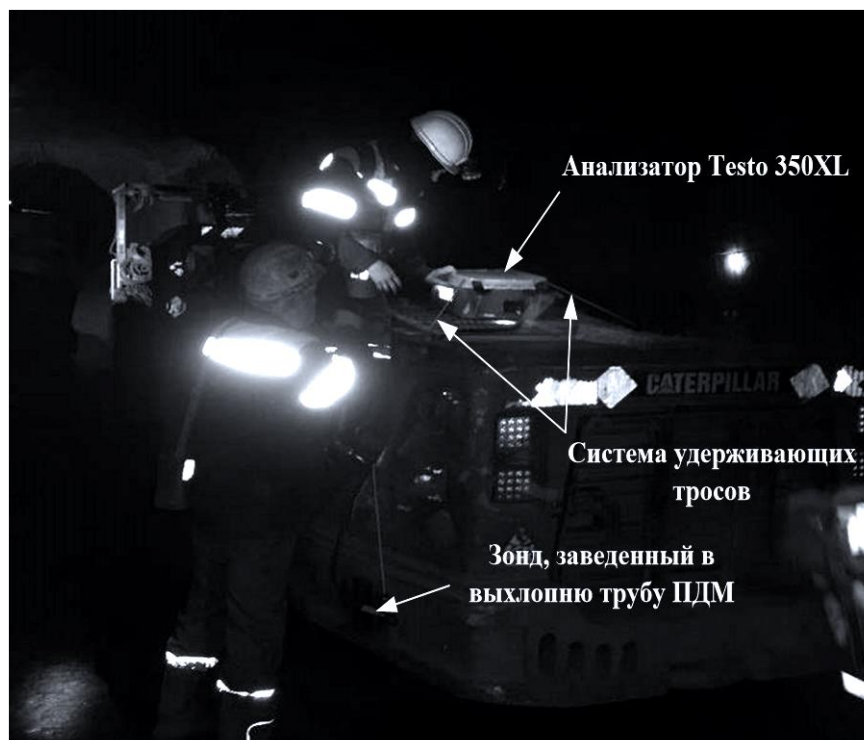
Рисунок П1.3 – Закрепление прибора на машине с ДВС
