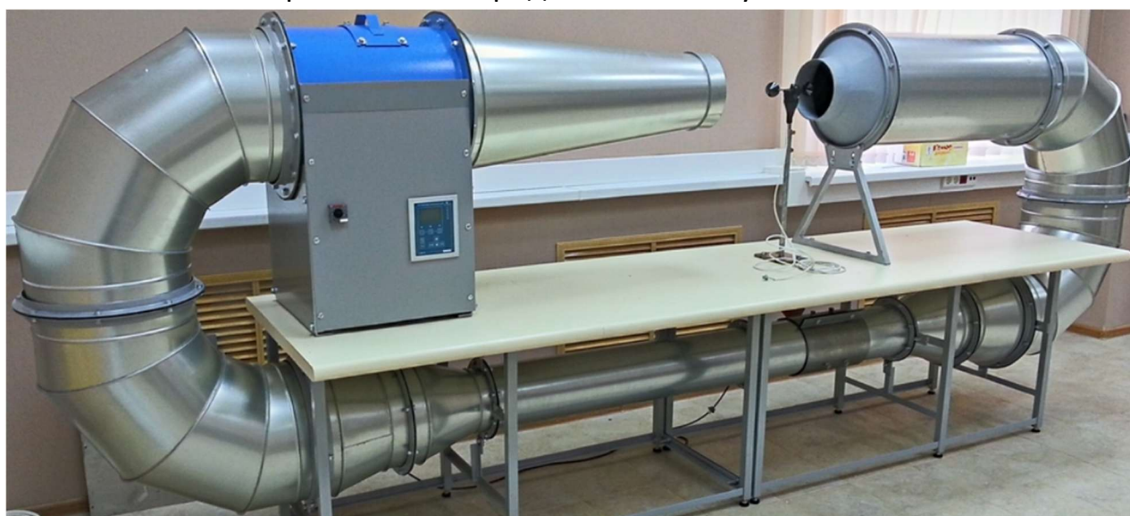
Рис. 3. Установка аэродинамическая замкнутого типа А-02з
