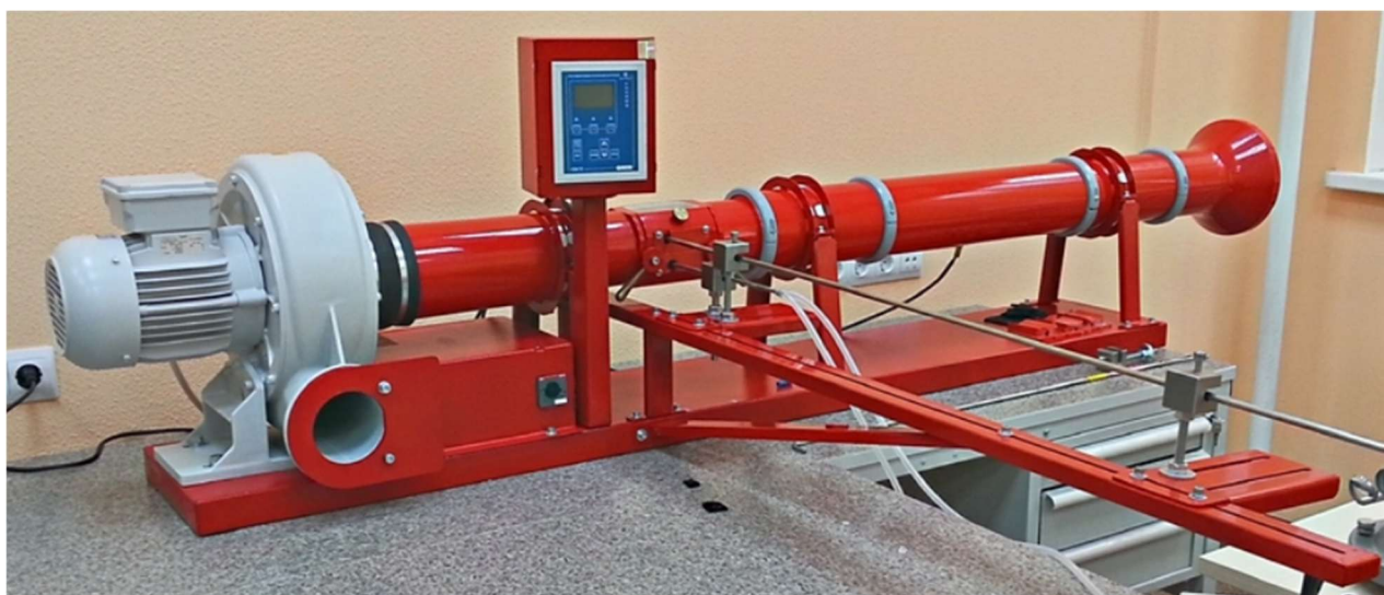
Рис. 2. Прямоточная аэродинамическая установка А-02в.
