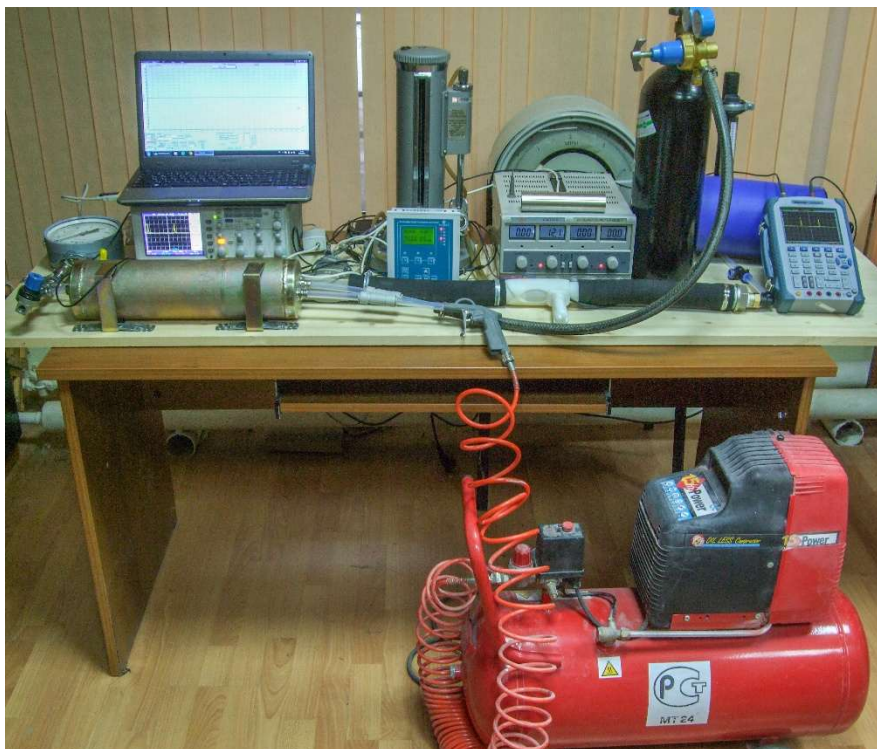
Рис 4.10. Стенд для исследования спирометров
