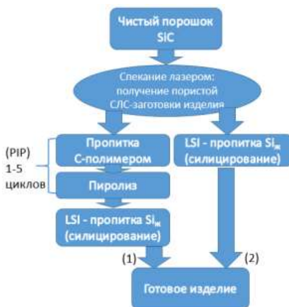
Рисунок 13 - Схема технологического процесса производства изделий из SiC
