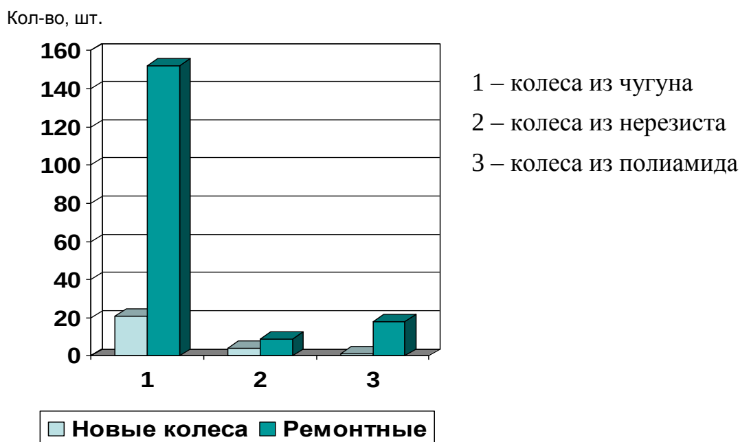
Табл. 5 Количество отказавших УЭЦН с разным типом материала рабочих колес:
