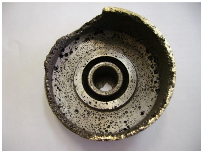
Рисунок 26. Дефекты на поверхности отливок — поры, раковины (после обычного литья).
