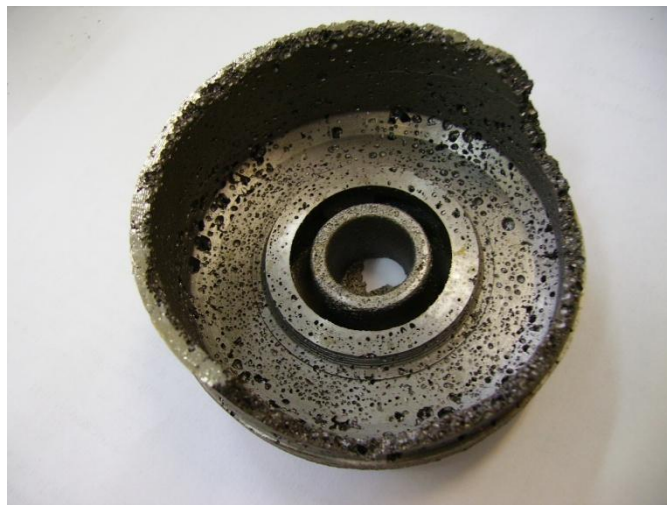
Рисунок 26. Дефекты на поверхности отливок — поры, раковины (после обычного литья).
