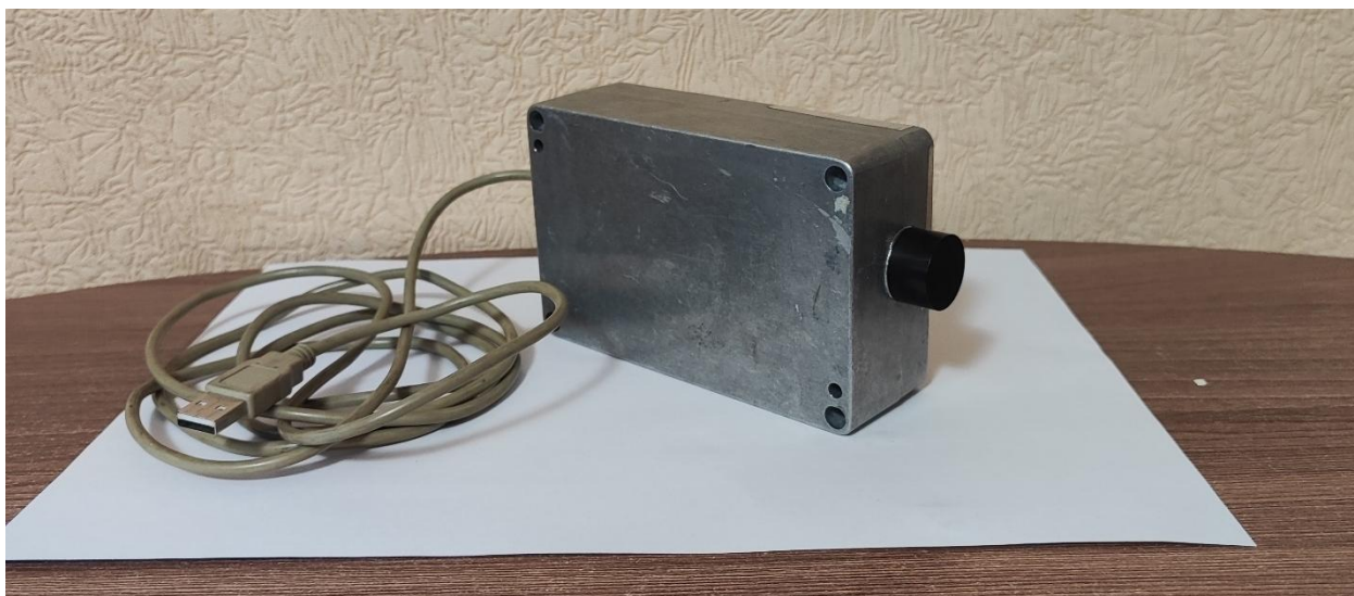
Рис.1.Общий вид датчик – зонда измерения параметров термоэмиссии горного массива
