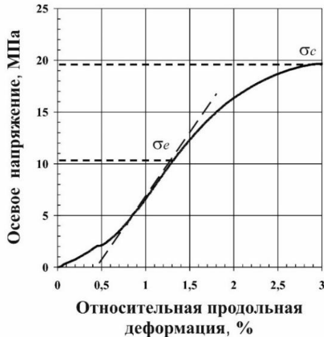
Рисунок 3.5 – Зависимость осевого напряжения от относительной продольной деформации при d\sigma/dt = \text{const} = 0,35 МПа/с
