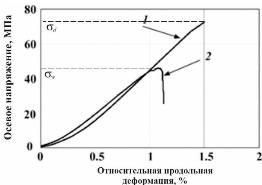
Рисунок 3.22 – Зависимости осевого напряжения \sigma от относительной продольной деформации для сухого (1) и водонасыщенного (2) образцов известняка при d\varepsilon/dt = \text{const} = 0,01 мм/с
