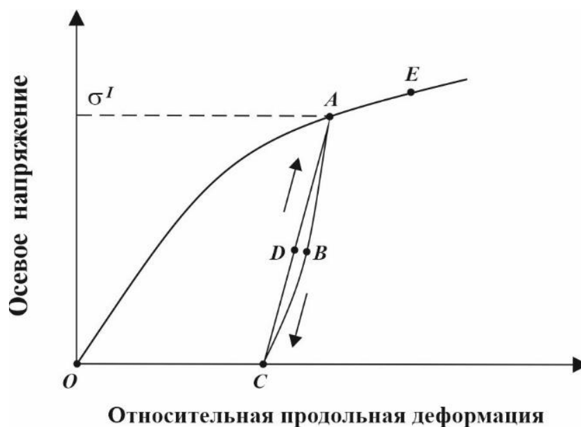
Рисунок 4.6 – Схематичное изображение зависимости «осевое напряжение – продольная деформация» для геоматериалов при их циклическом деформировании
