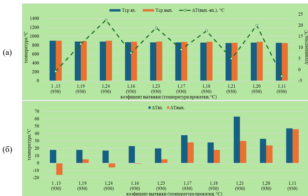
Рисунок 3.16 – Средняя температура прутка и разница между средней температурой входа и выхода (а) и разница между температурами переднего и заднего конца прутка (б), в каждом проходе прокатки по режиму № 2-2-1
