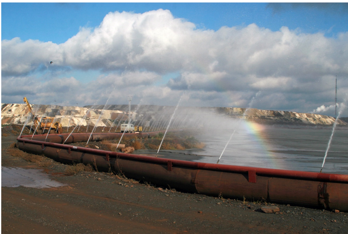
Рисунок 1.3.2 – Пылеподавление с помощью водяной завесы вокруг хвостохранилища
