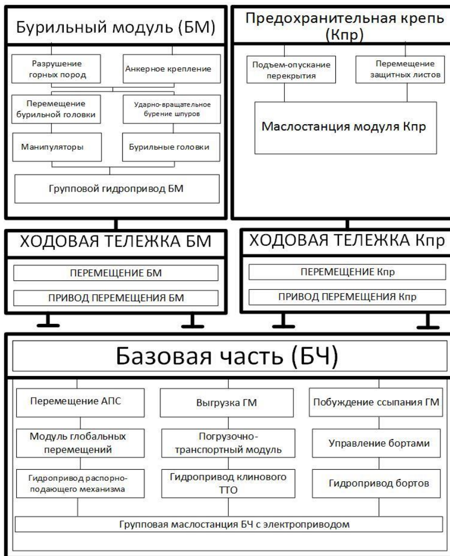
Рисунок 17 - Схема кинематического взаимодействия модулей
