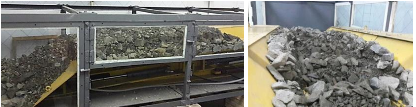
Рисунок 13 - Модель ПТМ при работе под завалом
