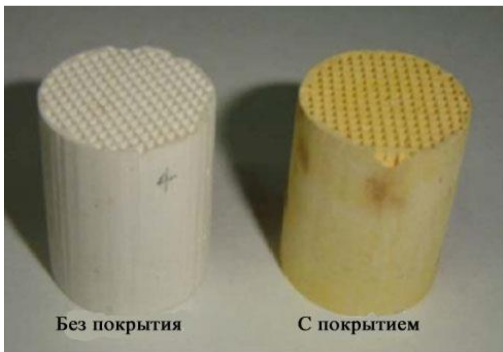
Рисунок 1.4 – Непокрытый и покрытый \text{Ce}_{0.98}\text{Pd}_{0.02}\text{O}_{2-\delta} кордиеритовый монолит
