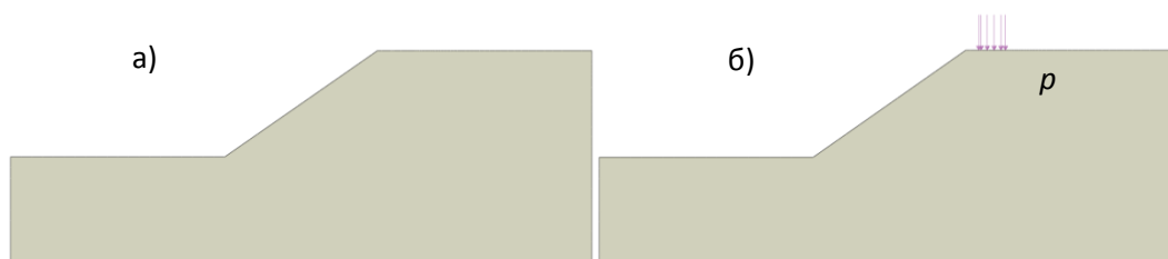
Рисунок 4.6 - Варианты расчетных схем в плоско-деформационной постановке для случая, когда тело отвала опирается на прочное основание (граничные условия условно не показаны): а – нагрузка от самосвала отсутствует; б – нагрузка от самосвала распределена по всей ширине отвала
