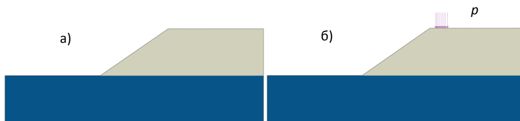
Рисунок 4.5 - Варианты расчетных схем в плоско-деформационной постановке для случая, когда тело отвала опирается на слабый слой грунта (граничные условия условно не показаны): а – нагрузка от самосвала отсутствует; б – нагрузка от самосвала распределена по всей ширине отвала
