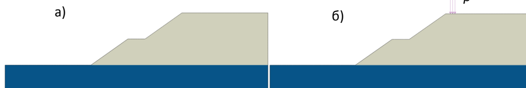
Рисунок 4.8 - Варианты расчетных схем в пространственной постановке для случая, когда тело отвала опирается на слой прочных пород (граничные условия условно не показаны): а – нагрузка от самосвала отсутствует; б – нагрузка от самосвала распределена по всей ширине отвала; в – нагрузка от самосвала распределена на площадь его основания
