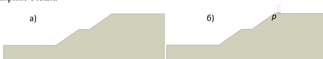
Рисунок 4.10 - Варианты расчетных схем в плоско-деформационной постановке для случая, когда тело отвала опирается на слой прочных пород (граничные условия условно не показаны): а – нагрузка от самосвала отсутствует; б – нагрузка от самосвала распределена по всей ширине отвала
