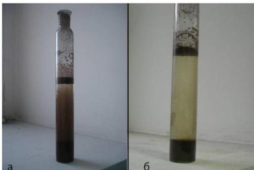
Рисунок 40 – Осаждение пыли электросталеплавильного производства
