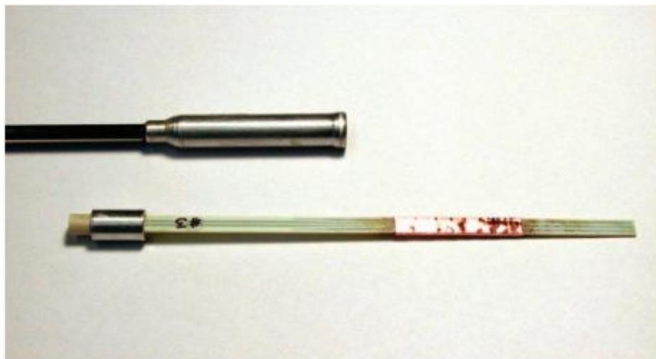
Рисунок 4.4 – Вид держателя образца со встроенной печкой
