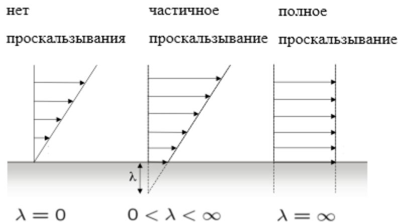
Рисунок 1.23 – К объяснению явления проскальзывания жидкости на границе с твердым телом: профили скоростей жидкости для различных длин проскальзывания  $\lambda$ . (рисунок адаптирован из [53]).
