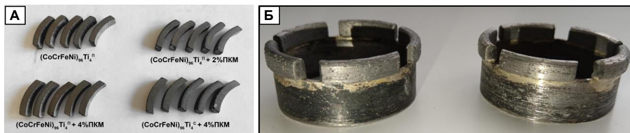
Рисунок 13 – Алмазные сегменты с разными типами связок (а); алмазные кольцевые сверла со связками CoCrFeNi_{96}Ti_4^{II} + 2\% ПКМ (слева) и CoCrFeNi_{96}Ti_4^C + 4\% ПКМ (справа) после испытаний
