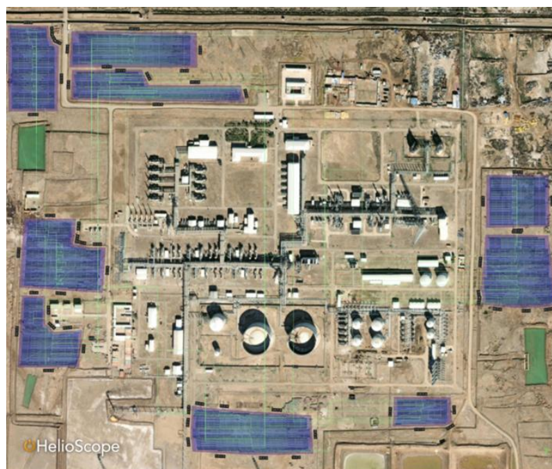
Рисунок 5 – Размещение солнечных панелей на территории месторождения Аль-Ахдаб и тепловая карта затенения (сегменты FS1–FS9)
