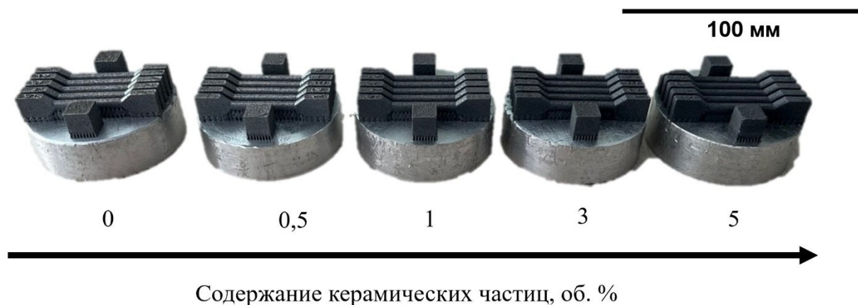
Рисунок 10 – Образцы композита \text{AlSi10Mg-ZrN} , изготовленного методом СЛП
