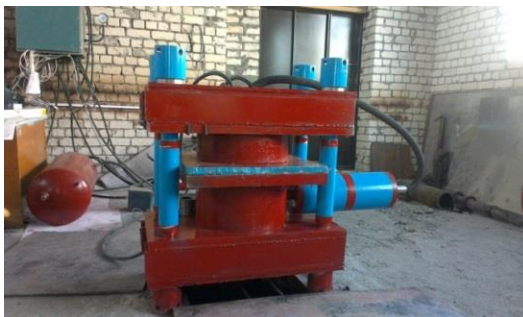
Рисунок 11 – Экспериментальная установка для газовой формовки с противодавлением
