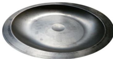
Рисунок 7 – Сферообразное днище с центральным углублением из стали
