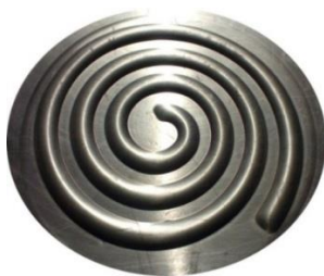
Рисунок 8 – Панель теплообменника со спиральным каналом из алюминиевой (А5М) заготовки толщиной 1мм
