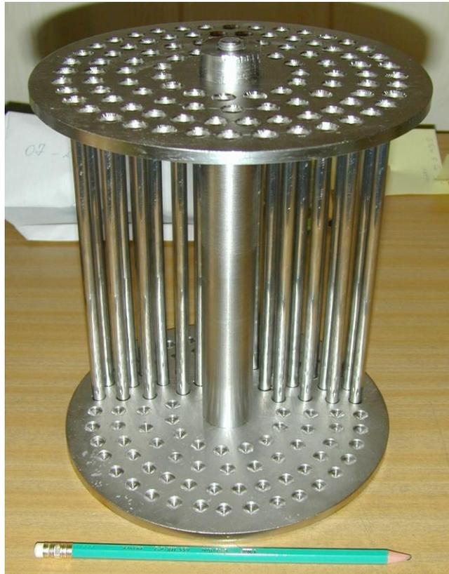
Рисунок 4.6 – Кассета из ниобия для высокотемпературного вакуумного отжига ниобиевых прутков  $\varnothing 7,4 \times 200$  мм
