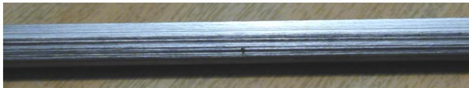
Рисунок 4.2 – Ниобиевый пруток размером под ключ  $S=5,4\text{ мм}$ , изготовленный по маршруту №1
