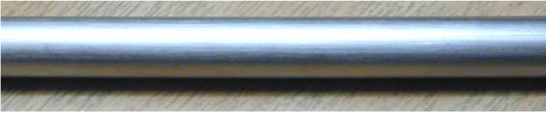
Рисунок 4.7 – Ниобиевый пруток  $\varnothing 7,4$  мм, изготовленный с применением прокатки
