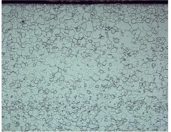
б)  $T = 1000\text{ }^{\circ}\text{C}$ ,  $\tau = 10\text{ мин}$ ,
