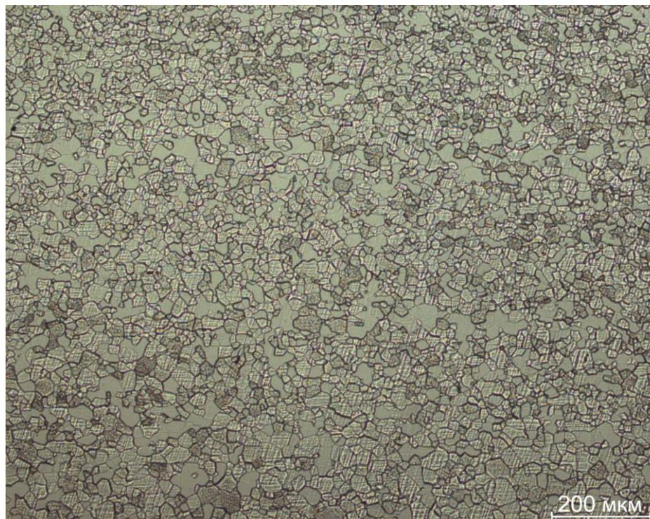
Рисунок 4.11 – Микроструктура ниобиевого прутка  $\varnothing 7,4$  мм, изготовленного по маршруту №4, после рекристаллизационного отжига по режиму 850 °С - 1 час; продольное сечение; x100
