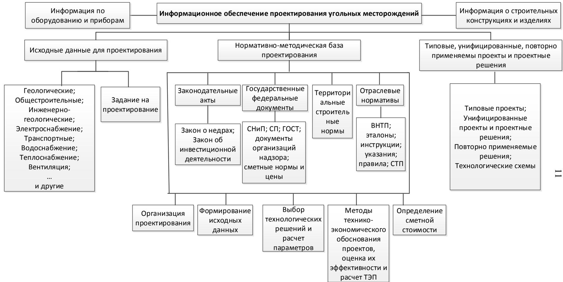
Рисунок 1- Блок-схема информационного обеспечения проектирования отработки запасов угольных месторождений
