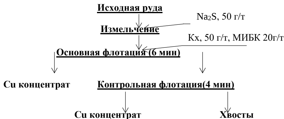
Рисунок 4.15 – Схема открытого опыта по флотации смешанных руд Жезказганского месторождения для получения черного медного концентрата с изменением времени измельчения.
