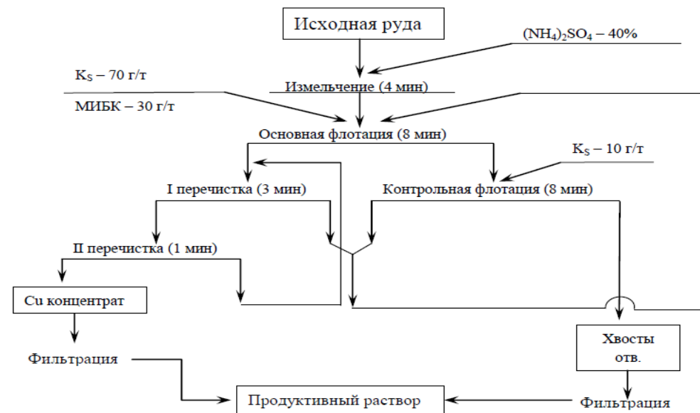
Рисунок 4.21 – Технологическая схема замкнутого цикла получения кондиционного медного концентрата с применением сульфата аммония в измельчении
