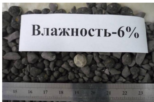
Рисунок 4.27 – Руда крупностью минус 20 мм после предварительной кислотной агломерации, загруженная на выщелачивание в лабораторную колонну
