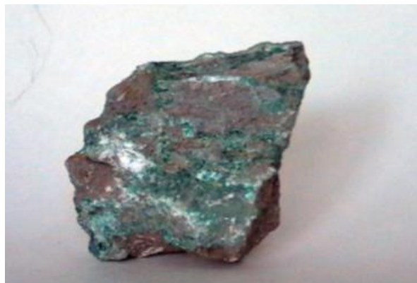
Рисунок 4.3 – Характер отложения малахита в трещиноватых алевроитах
