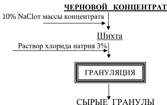
Рисунок 4.33 – Технологическая схема грануляции чернового концентрата
