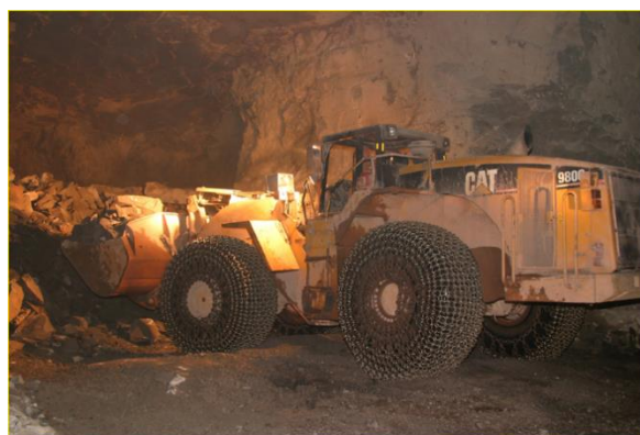
Рисунок 3.7 – Погрузка отбитой руды из целика ПДМ Caterpillar 980G
