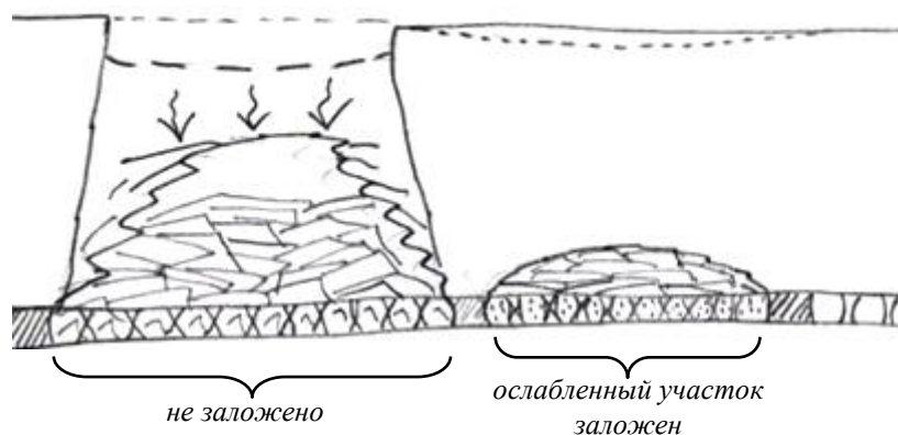
Рисунок 3.26 – Развитие обрушения до поверхности на незаложенных участках и его затухание в толще пород на заложенных участках
