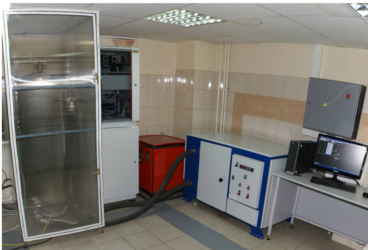
Рисунок 13 – Внешний вид установки МДО на базе инверторного источника питания и автоматизированной системы управления
