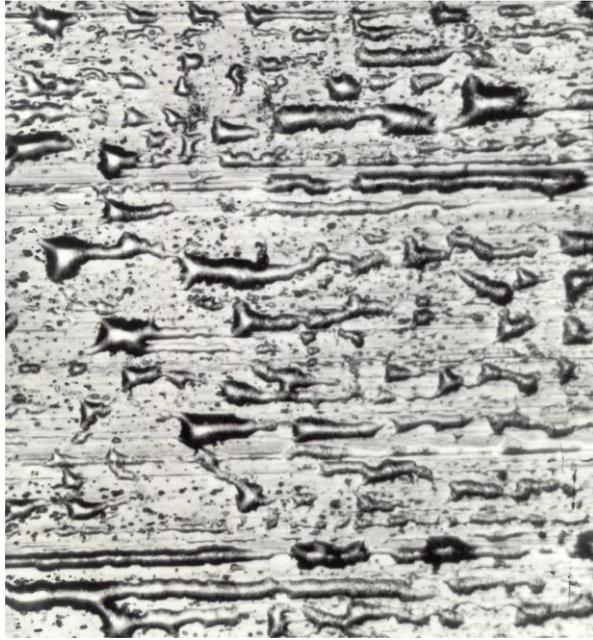
Рисунок 62 – Микрорельеф на контактной поверхности аморфной ленты сплава на основе железа  $\times 400$ .
