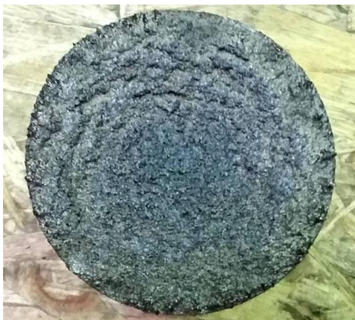
Рисунок 92 – Внешний вид торца расходуемой заготовки из сплава F-10H-3 после распыления
