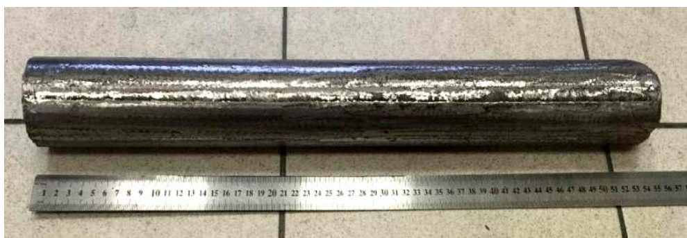
Рисунок 68 – Внешний вид слитка, полученного в результате ИП СВС- полуфабриката из сплава \text{Ni}_{41}\text{Al}_{41}\text{Cr}_{12}\text{Co}_6
