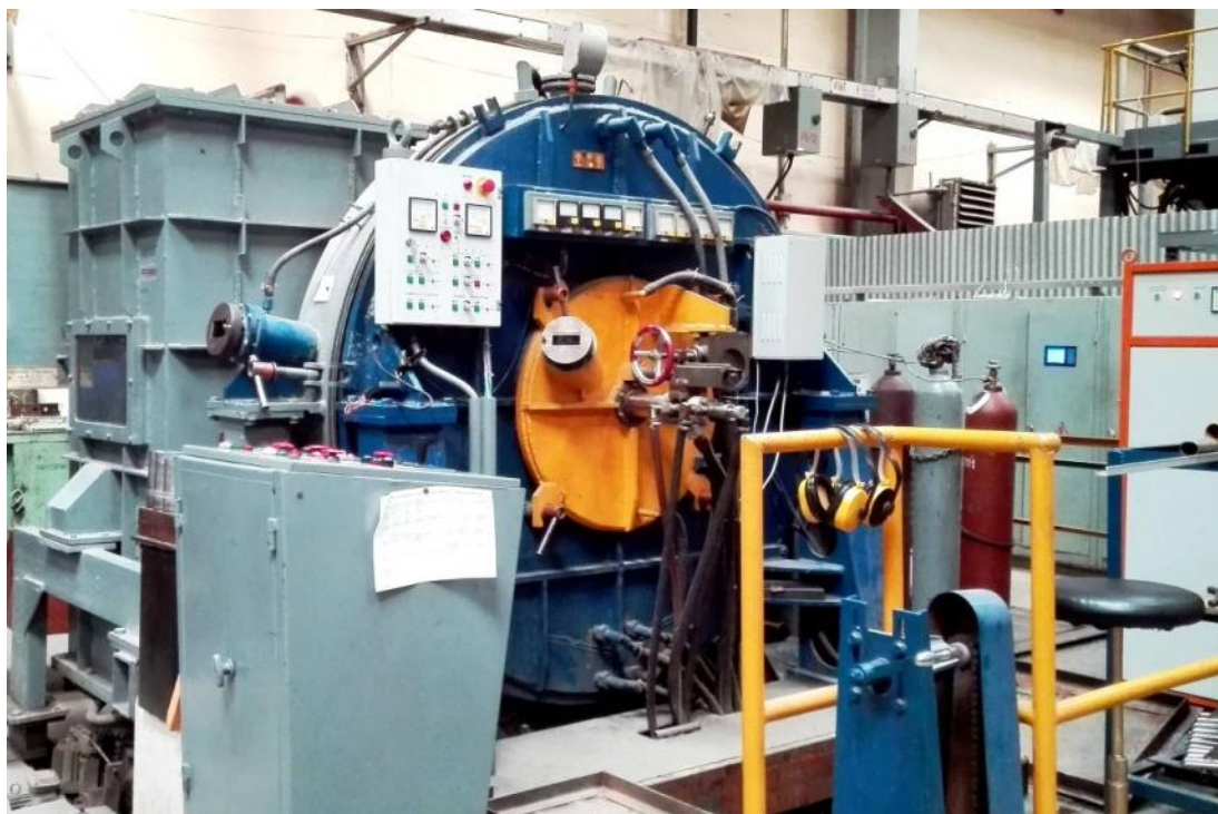
Рисунок 19 – Установка плазменного центробежного распыления УЦР-6К
