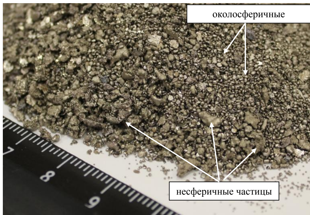
Рисунок 93 – Макроструктура крупной фракции порошка из сплава F-10H-3, полученного при I = 1100 \text{ A} , n = 10000 \text{ об./мин.}
