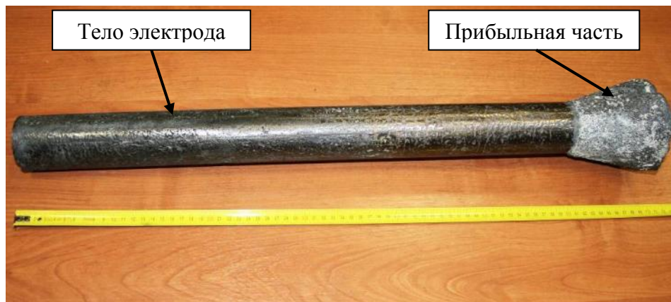
Рисунок 58 – Внешний вид слитки, полученного в результате ИП СВС- полуфабриката из сплава CompoNiAl
