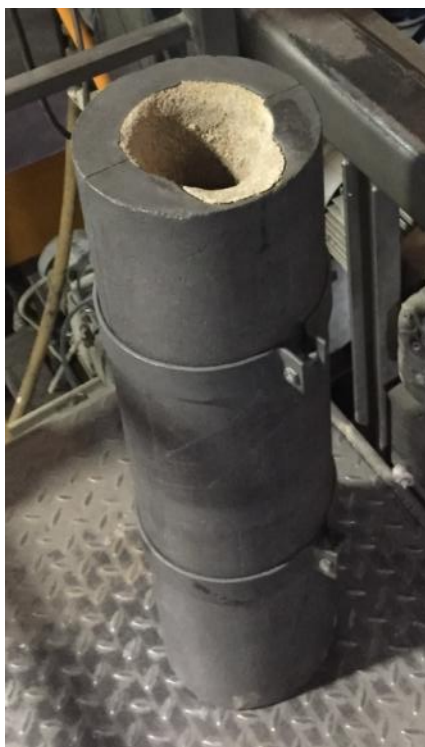
Рисунок 18 – Разборная графитовая форма изложницы, используемая для кристаллизации сплавов
