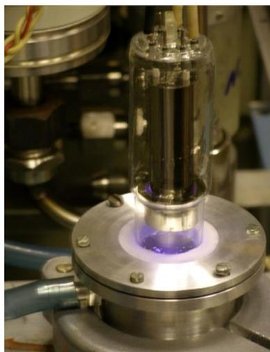
Рис. 61 Фотохимическая вакуумная камера ВУФ травления с работающей резонансной лампой вакуумного ультрафиолета КСР 2-1.
