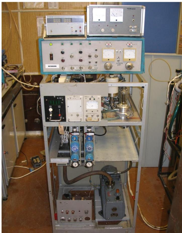
Рис. 60 Установка сухого безнагревного ВУФ травления образцов тонкоплёночных структур ПИ-пироэлектрик ДФТАв виде плёнки на кольце, изготовленная в ИПТМ РАН.
