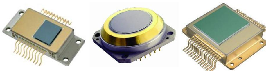
Рис. 3 Внешний вид неохлаждаемых микроболлометрических матриц на основе аморфного кремния
