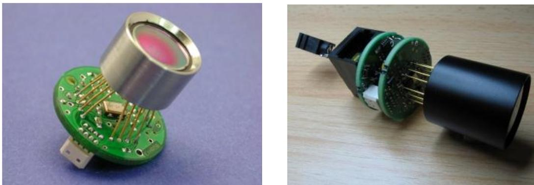
Рис. 16 Термопарная матрица и специализированный калиброванный модуль фирмы Heimann Sensor GmbH.
