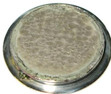
Рис. 22 Пироэлектрическая мишень в виде многослойной структуры на кольце Ø18 мм со стороны кристаллизованного пироэлектрического слоя ДФТА, покрытого слоем нихрома толщиной около 250 Å.
