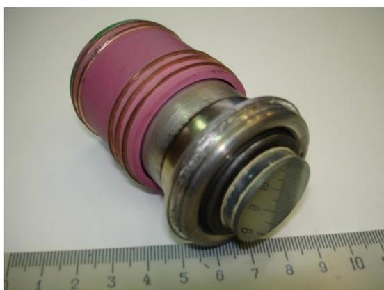
Рис. 44 Действующий образец пироЭОПа с мишенью  $\text{Ø}18$  мм на основе ДФТА в металло-керамическом корпусе (вакуум-плотная алюмооксидная керамика ВК94-1; сплав 29НК).
