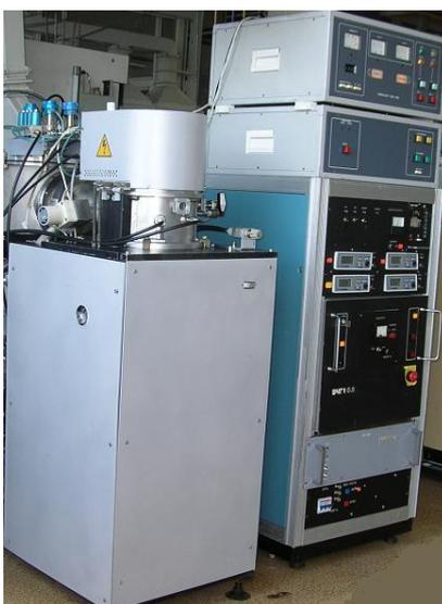
Рис. 57 Установка реактивного ионного травления «Плазмаком-203» с ICP источником плазмы и независимой подачей смещения на подложку.
