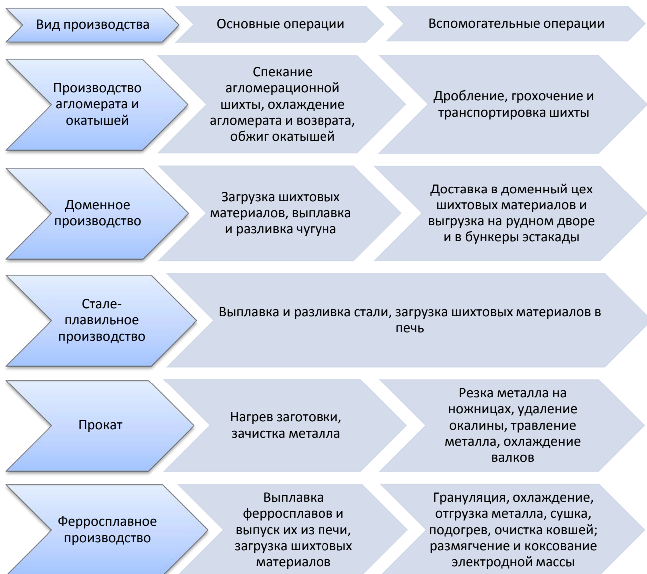
Рисунок 2 – Основные источники регламентированных газовых выбросов загрязняющих веществ металлургического предприятия и их назначение
