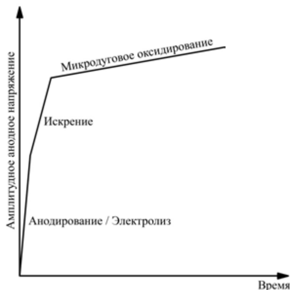
Рисунок 5. Стадии процесса микродугового оксидирования лёгких сплавов
