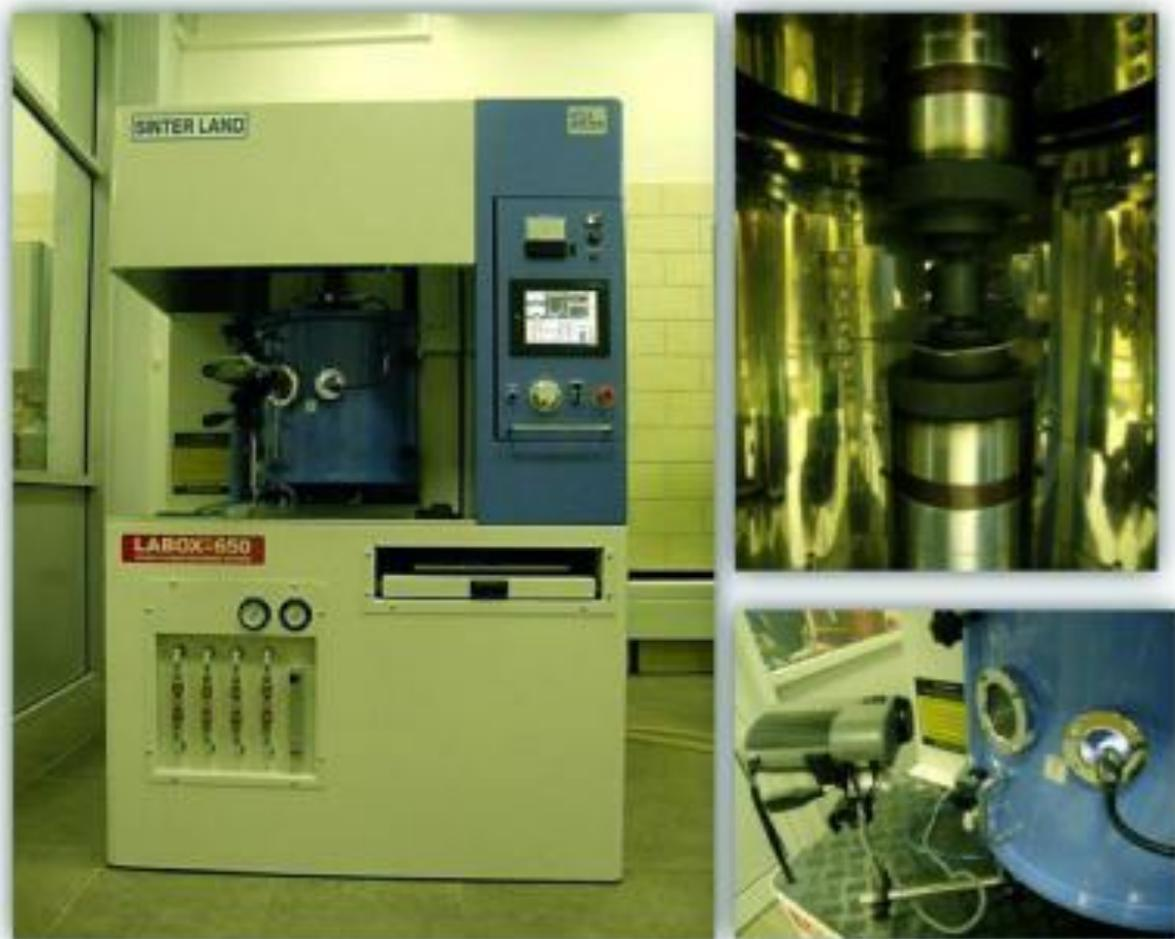
Рисунок 23 – установка искрового плазменного спекания Spark Plasma Sintering
