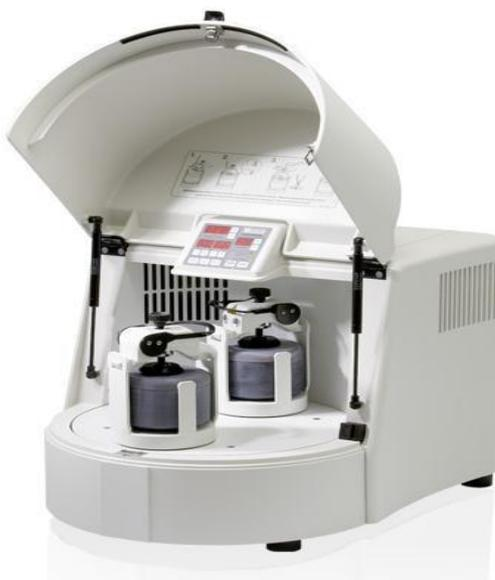
Рисунок 22 – Планетарная мельница Fritsch Pulverisette 5
