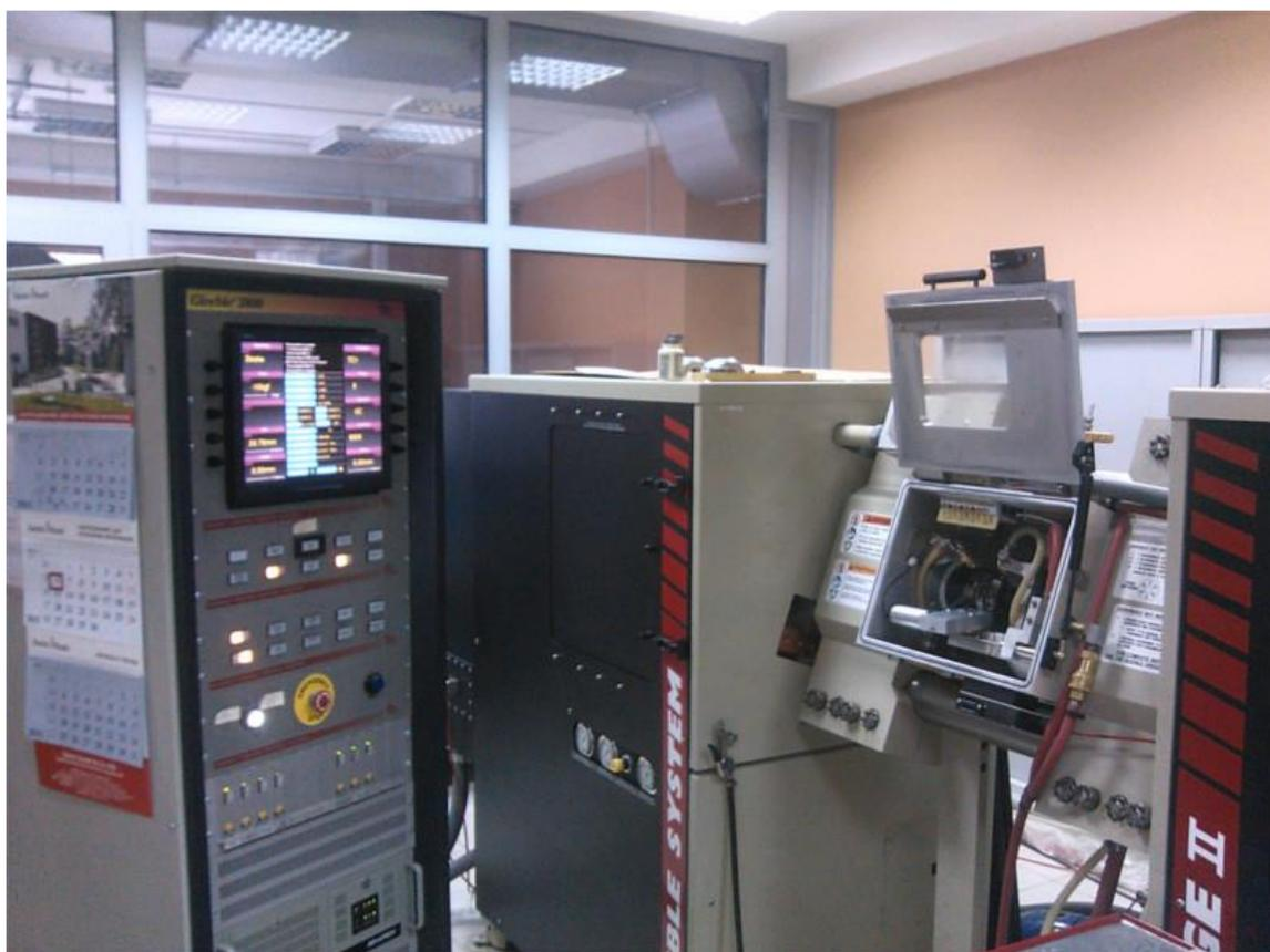
Рисунок 25 – Комплекс физического моделирования Gleeble 3800
