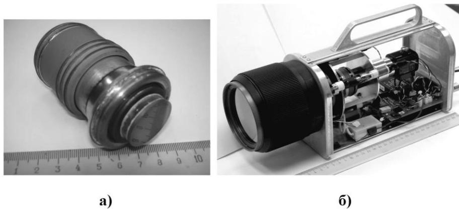
Рис. 12 а) действующий образец пироЭОПа с мишенью Ø18 мм на основе ДФТА в металло-керамическом корпусе (вакуум-плотная алюмооксидная керамика ВК94-1; сплав 29НК); б) компактный тепловизор на основе пироЭОПа.
