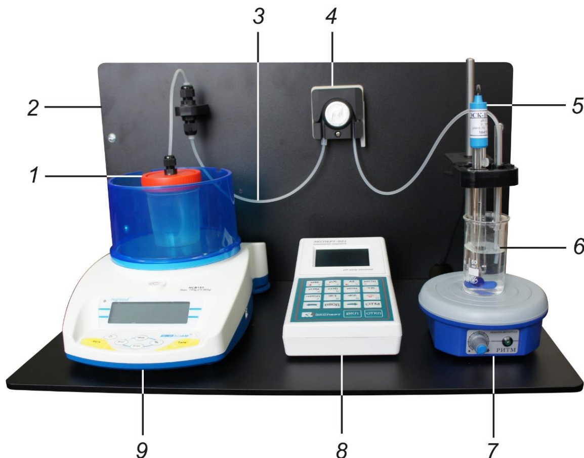
Рисунок 2.9 – Внешний вид прибора в сборе. 1 – стакан с раствором титранта, 2 – корпус, 3 – трубка насоса, 4 – перистальтический насос, 5 – электродная система, 6 – стакан с анализируемым раствором, 7 – магнитная мешалка, 8 – анализатор «Эксперт-001», 9 – весы
