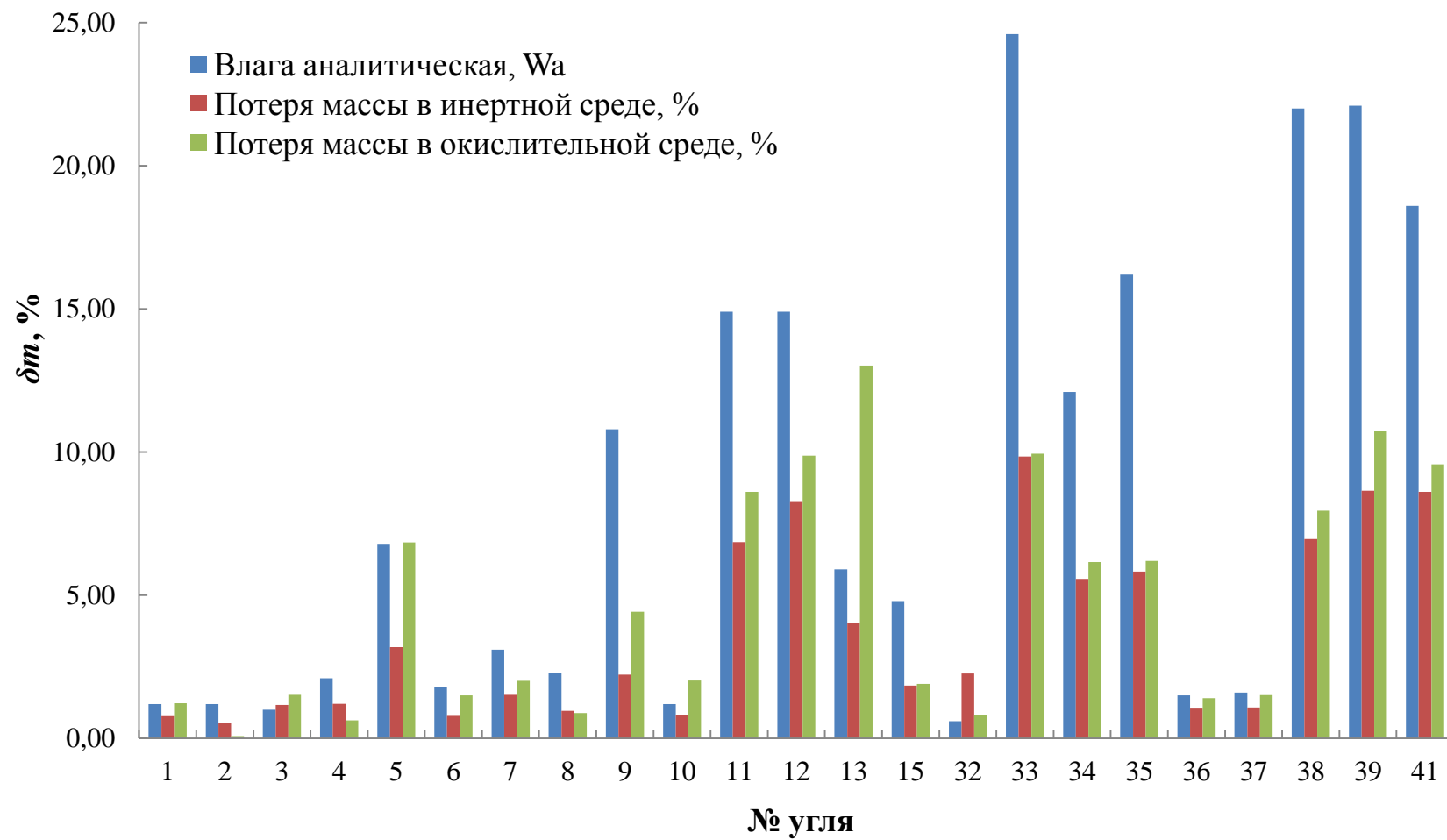
Рисунок 3.10 – Корреляция величин потери массы на образцах углей при ТГ-анализе со значениями аналитической влаги
