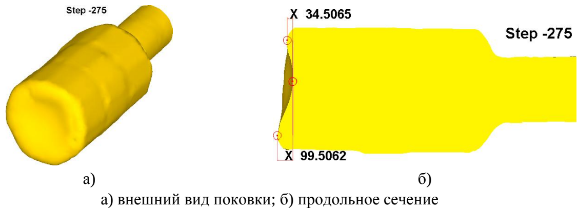
Рисунок 5.58 – Внешний вид и продольное сечение поковки после протяжки
