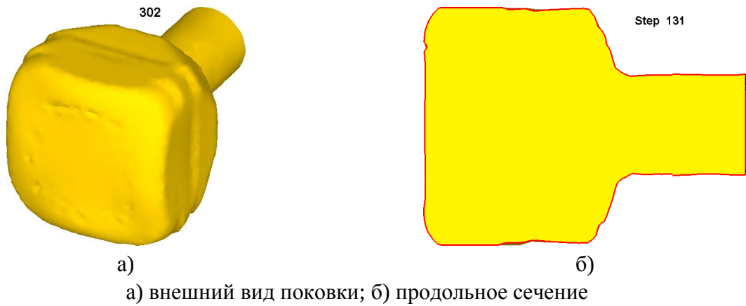
Рисунок 5.51 – Внешний вид и продольное сечение поковки после протяжки до квадратного поперечного сечения
