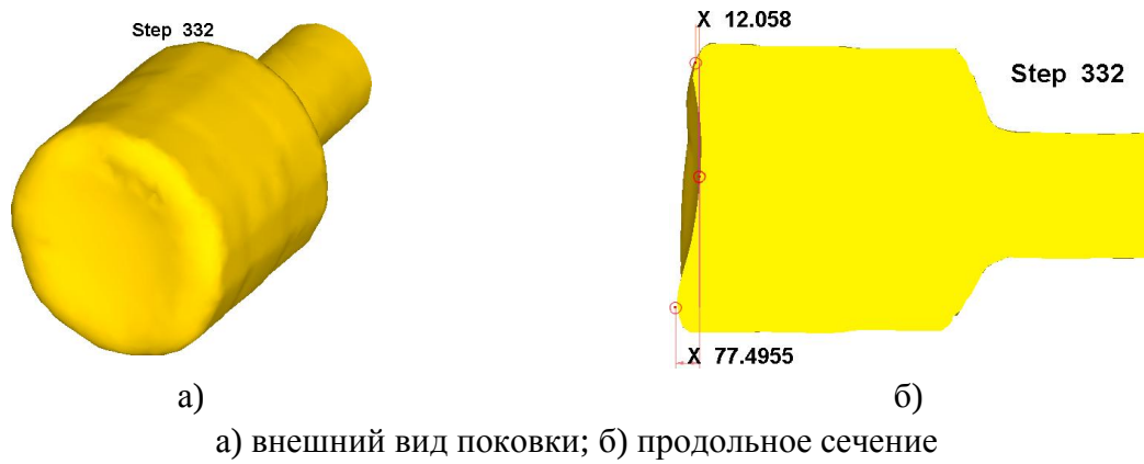
Рисунок 5.57 – Внешний вид и продольное сечение поковки после протяжки
