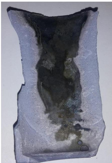
Рисунок 59 – Внутренняя поверхность тигля в месте взаимодействия металла и футеровки на плавке №8 (без присадки алюминия); концентрация алюминия в металле - 0,074%
