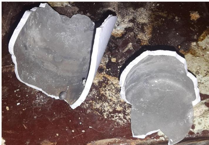
Рисунок 58 – Внутренняя поверхность тигля в месте контакта с металлом на плавке №6, в ходе которой в металл присаживали алюминий на 0,088%, конечная концентрация алюминия - 0,181%.
