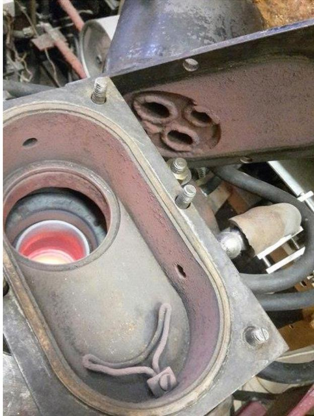
Рисунок 57 – Фотография стенок вакуумной печи сопротивления после 4 плавок.
