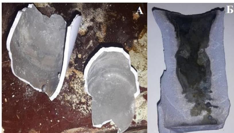
Рисунок 12 – Внутренняя поверхность тигля в месте контакта с металлом на плавке А-№6(с присадкой алюминия) и Б-№8 (без присадки алюминия).
