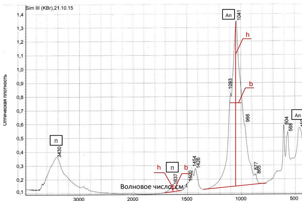
Рисунок 5 - Пояснение количественного анализа адсорбции флокулянта на шламовом классе АШР по данным ИК-спектроскопии: Ап – пики поглощения апатита; П – пики поглощения «Праестола- 2530»; h – высота пика поглощения; b – ширина пика поглощения
