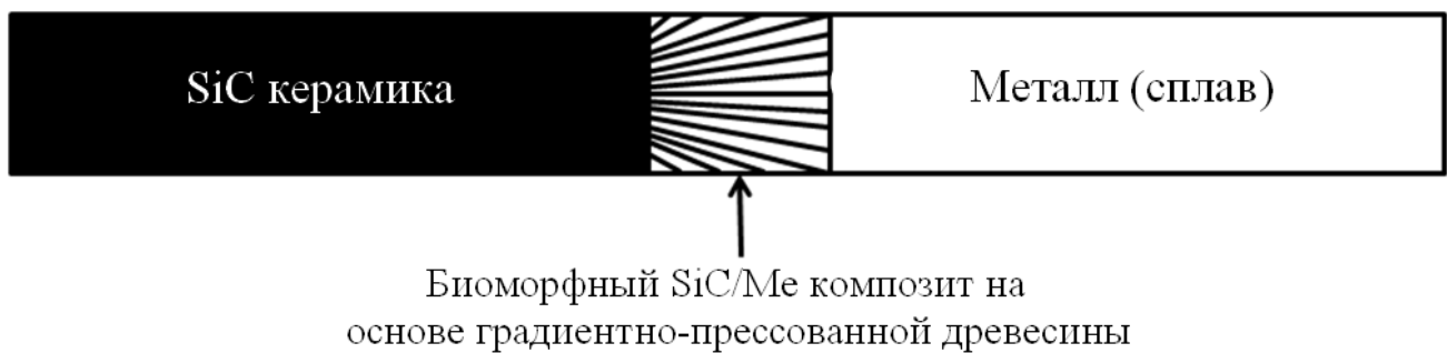
Рисунок 5 – Схема сварки керамических и металлических деталей..
