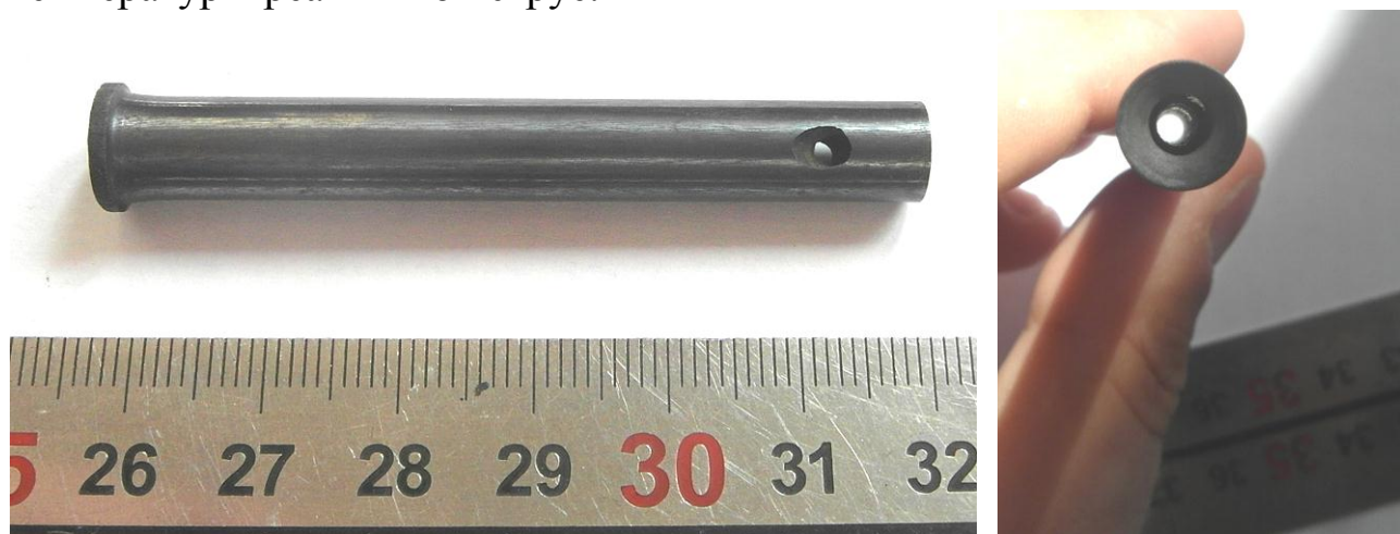
Рисунок 3 – Наконечник корпуса измерителя температур газового потока в газотурбинной камере, изготовленный из биоморфного SiC/Si/C композита.
