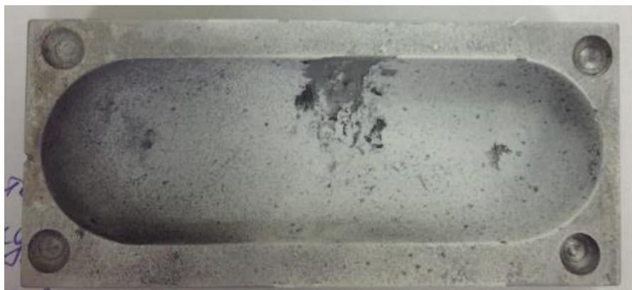
Рисунок 3.9 Продукты прямого синтеза наноструктур ВN из бората Li.
