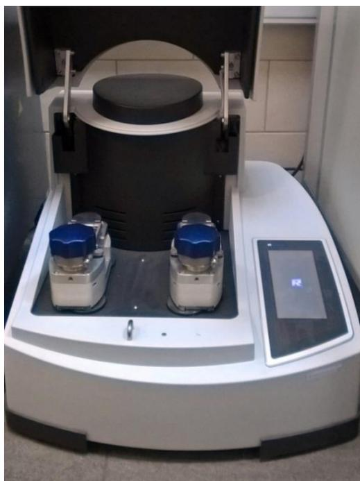
Рисунок 2.5 Высокоэнергетическая шаровая мельница.
