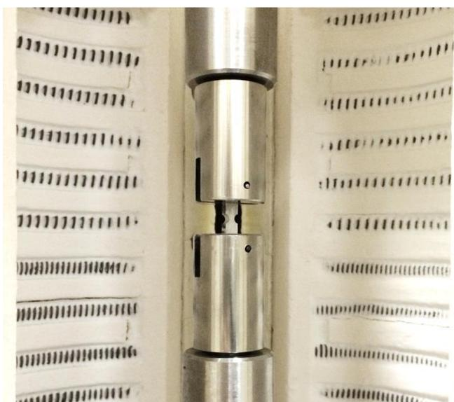
Рисунок 2.10 Фотография образца, размещенного в зажимах, для высокотемпературных испытаний.
