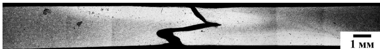
Рисунок 6.11 – Поперечное сечение разрушенного образца сварного соединения УМЗ листов сплава 1570С
